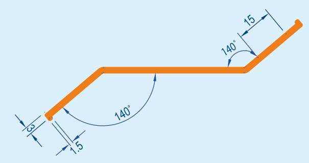
Strangpressprofil Aluminium Z-Lamelle
