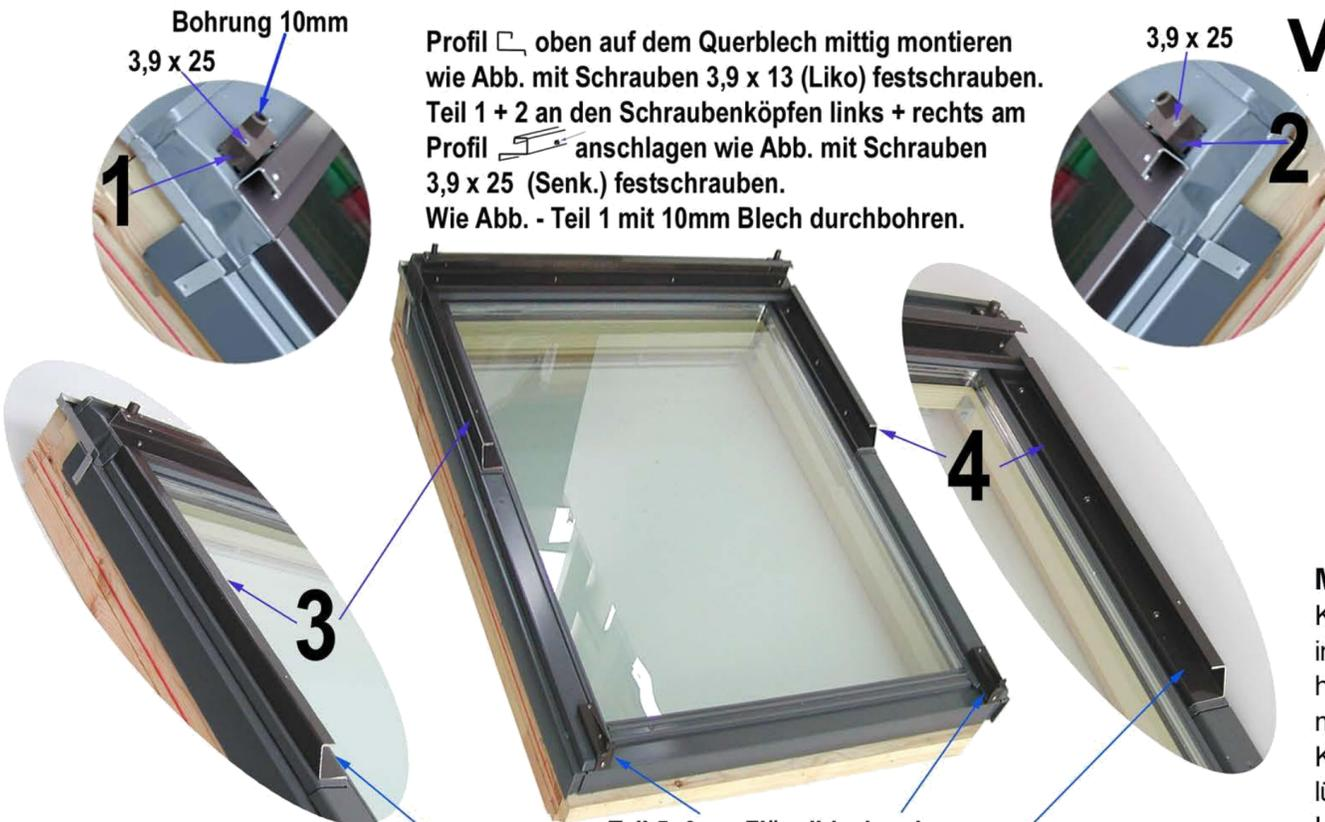
Profil oben auf dem Querblech mittig montieren wie Abb. mit Schrauben 3,9 x 13 (Liko) festschrauben. Teil 1 + 2 an den Schraubenköpfen links + rechts am Profil anschlagen wie Abb. mit Schrauben 3,9 x 25 (Senk.) festschrauben. Wie Abb. - Teil 1 mit 10mm Blech durchbohren.
